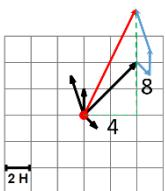
Равнодействующая сила равна векторной сумме сил, действующих на материальную точку. Длину полученного графическим способом вектора равнодействующей силы (красный) находим по теореме Пифагора:
